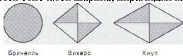
Рис. 6. Вид отпечатка индентера на поверхности образца для различных видов твердомеров.
